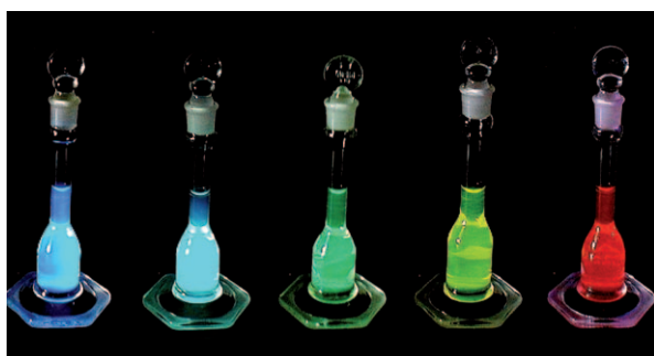
Abbildung 1. Fluoreszenz von Methanol-Lösungen von PPE-Ar-SO 3 - ( 14 ) unter Bestrahlung mit Nah-UV-Licht. Von links nach rechts: Ph, Py, Th, EDOT und BTDT. (Aus Lit. [48].)
